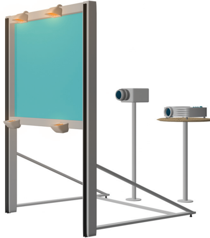
Abbildung 5.3: Rückprojektionsaufbau. (Grafik von Verena Lugmayr)
